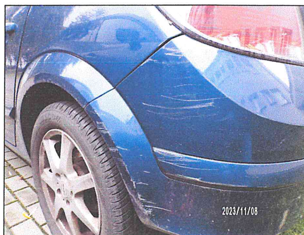
Uszkodzenia listew dachowych i zarysowania eksploatacyjne zderzaka i błotnika TL
